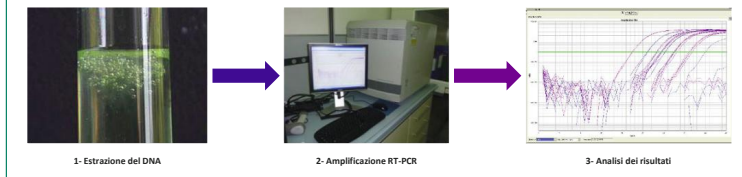
Figura 2 - Le fasi dell'analisi qualitativa in Real - Time PCR per la ricerca del promotore CaMV 35S e del terminatore NOS
