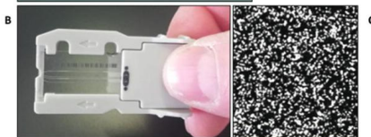
FIGURA 2 (A) Sequenziatore MiSeq Illumina. (B) Flowcell in cui avviene il processo di creazione di cluster e sequenziamento. (C) fotografia di un Tile, ossia una parte in cui è diviso il vetrino della FlowCell, scattata durante il sequenziamento
