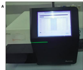
FIGURA 2 (A) Sequenziatore MiSeq Illumina. (B) Flowcell in cui avviene il processo di creazione di cluster e sequenziamento. (C) fotografia di un Tile, ossia una parte in cui è diviso il vetrino della FlowCell, scattata durante il sequenziamento
