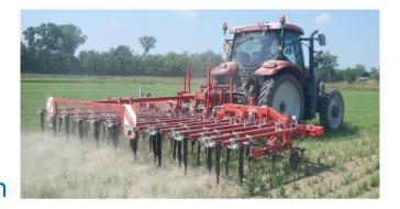
41 zappette singole di tipo vibro a zampa d'oca e di geometria lanciforme
