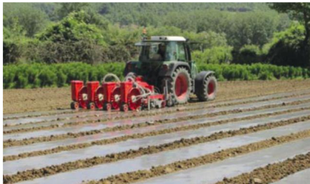
La macchina Spapperi pacciamasemestrata al lavoro: 4 file su 2 prosa (piastrelle piane) binate pacciamate
