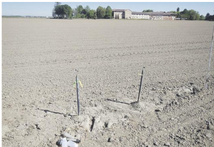
Coppe porose di ceramica per il campionamento della soluzione circolante a 25 e 65 cm di profondità
