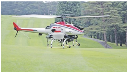
Elicottero Yamaha R-max in grado di trattare le risie giapponesi distribuendo prodotti fitosanitari liquidi, non impiegabile in Italia
