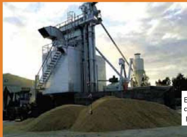
Essiccatore pneumatico con elevatore passaggio secco
