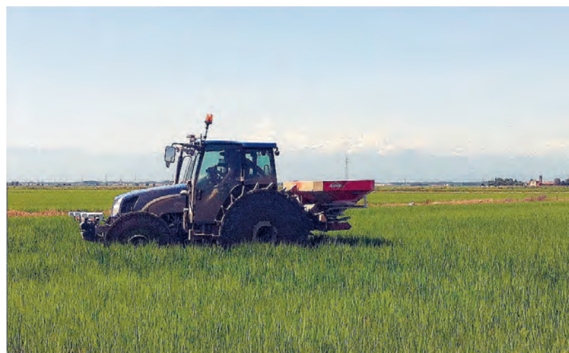
A fianco, l'irroratrice con controllo automatico chiusura sezioni e, sopra, lo spandiconcime a dosaggio variabile utilizzato alla Tenuta Motta di San Pietro Mosezzo
