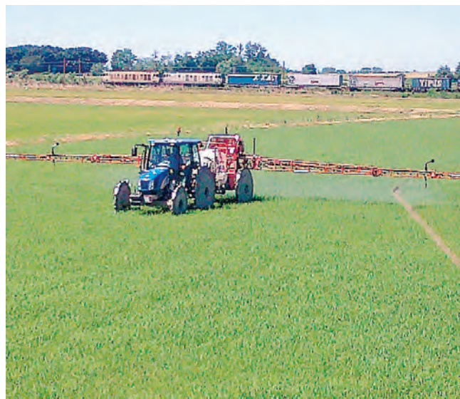
A fianco, l'irroratrice con controllo automatico chiusura sezioni e, sopra, lo spandiconcime a dosaggio variabile utilizzato alla Tenuta Motta di San Pietro Mosezzo
