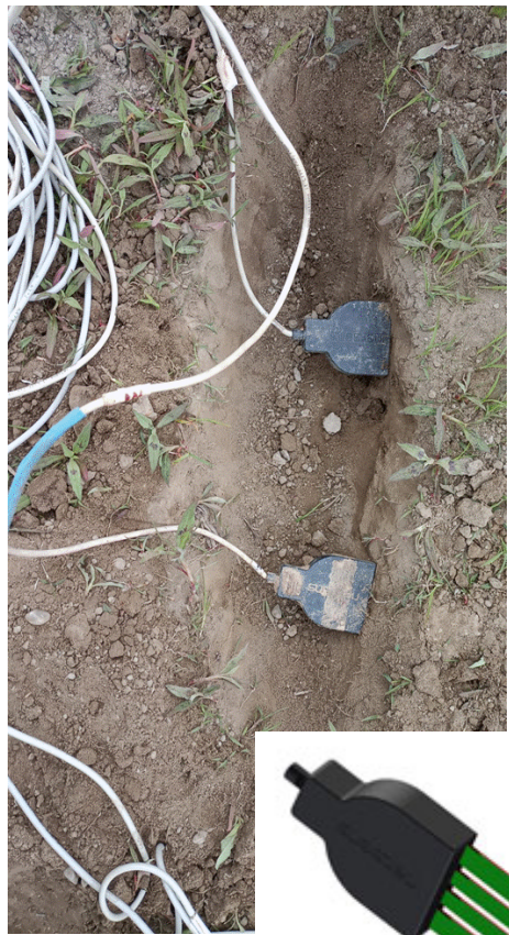
Sonde di umidità
