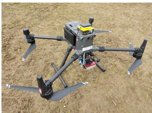
Drone e camera impiegati per il rilievo multispettrale:
